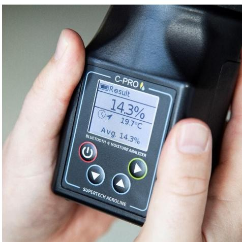
**Примечание. Для обеспечения правильных показаний замеров после каждого измерения тщательно очищайте оба жернова прилагаемой кисточкой для очистки. Остатки липкого или влажного материала можно удалить путём измельчения сухого образца зерна.**
